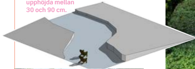
En ravin där en sida är uppbyggd av sprängsten.
